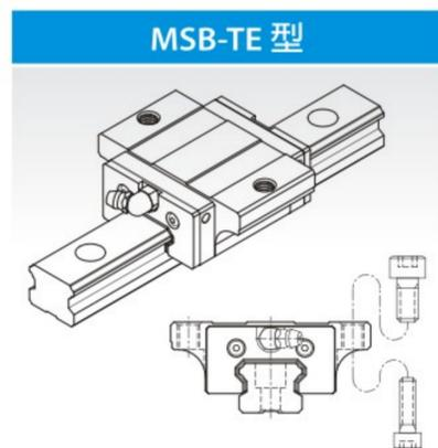
除了可從滑塊的上面進行裝配外，同時又適用於工作台無法開安裝螺柱用貫穿孔的狀況下，從滑塊的底面往上進行裝配。
