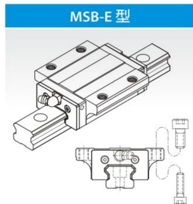
與MSB-TE型具有相同断面尺寸，增加滑塊的長度，並增加負荷鋼珠數，提昇整體的負荷能力。
