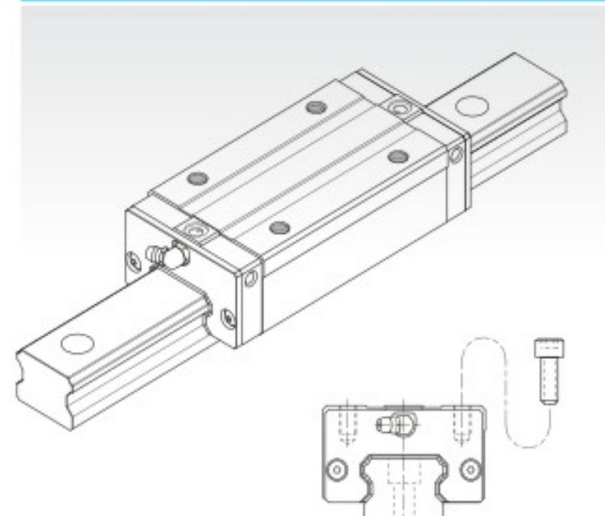
與SME-SB / SME-SV型具有相同斷面尺寸，增加滑塊的長度，並增加負荷滾珠數，提昇整體的負荷能力。
